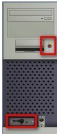
Gambar 4 : WLAN Card sudah terpasang
